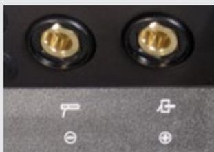
Аппарат MIG-MAG, который умеет работать и с электродами. Достаточно просто снять горелку, подключить электрододержатель к дополнительному разъёму для электродов и выбрать электродную сварку на пульте управления.
