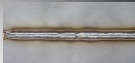
I-шов, CrNi t = 0,5 мм, без воздушного зазора
