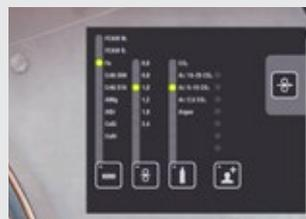
Аппарат MicorMIG, начиная с версии BasicPlus, предлагает большое количество сварочных программ для различных комбинаций материалов / проволоки / стекла. Настройка программ осуществляется в зависимости от исполнения у катушки с проволокой в подающем механизме или на узле подачи проволоки компактного аппарата.
