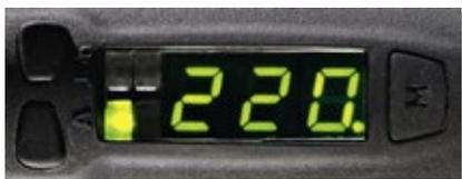
Регулировка сварочного тока с точностью до ампера и выбор заданий – это фиксированные функции, а для двух других светодиодов можно назначить иные
