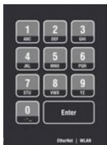
Посредством числового блока, интегрированного в пульт управления, возможен прямой ввод номеров заказов, деталей или WPS. Также возможен ввод и буквенно-числовых данных. Специальной клавиатуры для этого не требуется.
