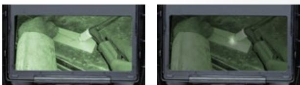
Горелка и сварочная проволока, оптимальное расположение
