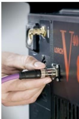
LorchNet. Только соединительный кабель необходим при сварке вручную для подключения к аппаратам Lorch. Также при автоматизированной сварке для подключения к LorchControl, центральному блоку управления системой автоматизации компании Lorch. Ваши преимущества: Максимальная надежность и очень быстрый ввод в эксплуатацию. Просто подключи и сваривай.
