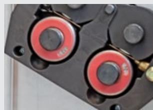
Путаница с установкой роликов осталась в прошлом. Подающие ролики Lorch для MicorMIG с цветовой маркировкой обозначают различные диаметры проволоки и существенно облегчают жизнь сварщика.
