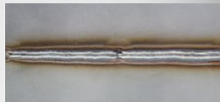
I-шов, CrNi t = 0,8 мм, воздушный зазор = 0,8 мм
