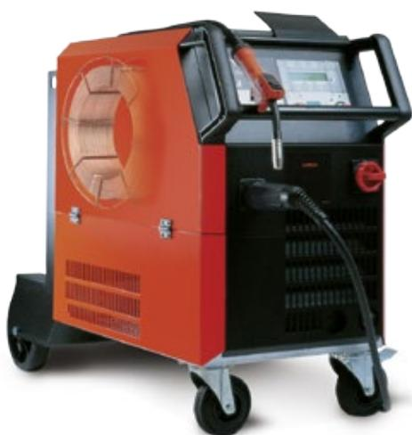
**В компактном исполнении.** Передвижной компактный аппарат со встроенной подачей проволоки
