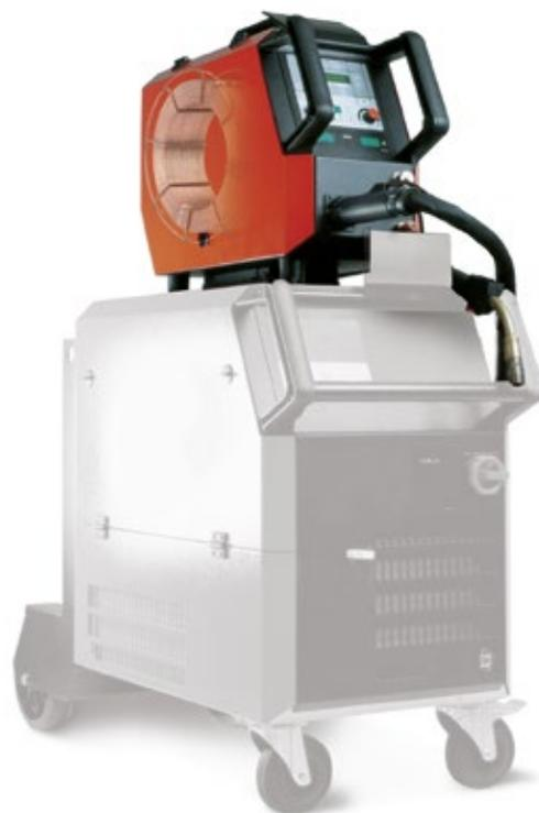
**В блоке подачи проволоки.** Так Вы получаете возможность работать на расстоянии 25 м от аппарата. В качестве связующего звена выступает шланг-пакет.
