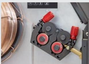
Серийная высокоточная 4-роликовая система подачи проволоки впечатляет своей надёжностью, компактностью и возможностью замены роликов без инструментов. Система подачи проволоки легко переоснащается на вариант с приводом 4/4 путём простой замены роликов.
