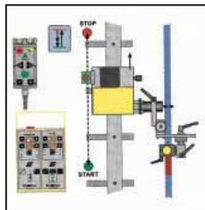
Система дополнена устройством выбора положения начала и конца сварки и возврата на заданную длину. Оснащена пультом дистанционного управления оригинальной конструкции, для сварки различных изделий.
