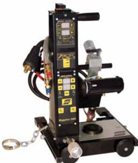
**Miggytrac 3000** (Миггитрак 3000) — небольшой и компактный моторизированной трактор, совмещенный с механизмом подачи проволоки и водяным охлаждением сварочной горелки, разработанный для MIG/MAG сварки листов и металлоконструкций.
