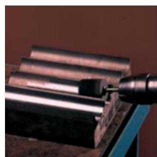
**Formpolierkörper** zum Feinschleifen und Mattpolieren von Stahl, Aluminium und NE-Metallen im Formen- und Werkzeugbau, Apparatebau etc.
