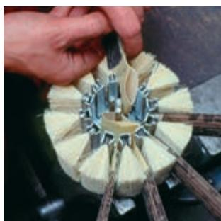
**Bürstenschleifkopf** zum Feinschleifen von rostfreiem Stahl, Aluminium etc. für Trockenschliff oder mit Subol-Schleiföl, siehe Seite 81. Zur Erzielung des Bürstenstricheffektes. Schleifbänder Silicium-Carbid, kunstharzgebunden.
