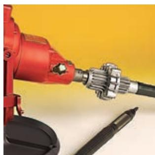
**Biegsame Wellen**, bestehend aus Wellenseele mit Kupplungen, Gummischutzschlauch mit Verstärkungsstulpen und Kupplungen.
