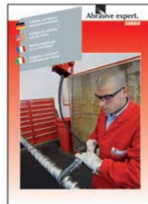
Schleifen + Polieren von Extruderschnecken
